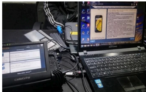
Fig. 7. Testeos realizados durante una extracción de Ufed Touch II y Ufed4PC en laboratorio móvil.
