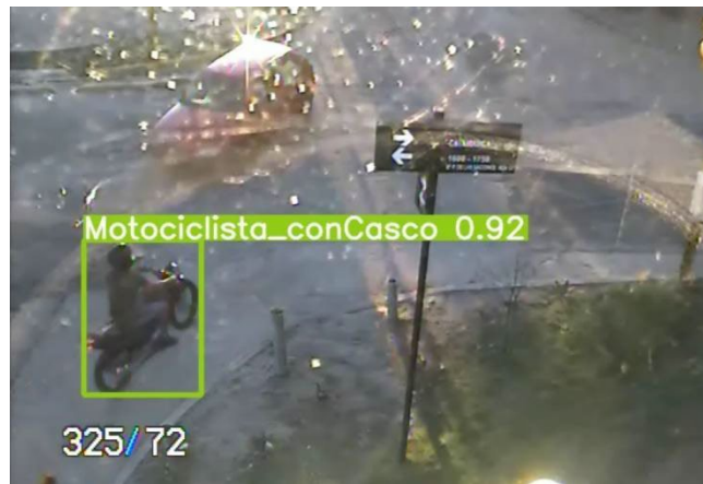
Fig. 15. Detalle de detección, rastreos y nivel de confianza.
