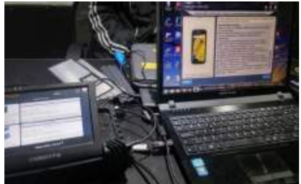
Fig. 7. Testeos realizados durante una extracción de Ufed Touch II y Ufed4PC en laboratorio móvil.
